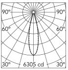
Luminous flux luminaire 1467 lm
