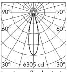
Luminous flux luminaire 1467 lm
