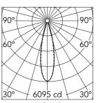
Luminous flux luminaire 1418 lm
