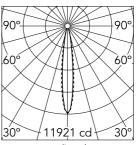
Luminous flux luminaire 1459 lm
