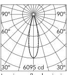
Luminous flux luminaire 1418 lm
