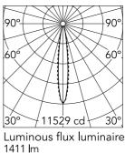
14° Beam Angle: E(Ix) D(m) h(m) 0.25 11529 1 2 2882 0.50 3 1281 0.74 0.99 4 721 5 461 1.24
