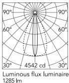
13° Beam Angle: D(m) h(m)  $E(\mathbf{I}_{X})$ 0.22 4542 1 2 1136 0.44 3 505 0.66 0.88 4 284 5 182 1.10
