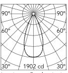
Luminous flux luminaire 1273 lm
