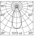
Luminous flux luminaire 682 lm
