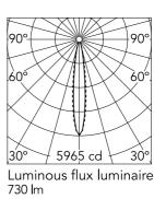
Beam Angle: 14° h(m) E(Ix) D(m) 1 5965 0.25 2 1491 0.50 3 663 0.74 4 373 0.99 5 239 1.24
