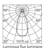
45° Beam Angle: D(m) E(Ix)h(m) 0.83 1019 255 1.65 3 113 2.48 3.31 4 64 5 41 4.13
