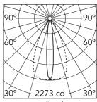
Luminous flux luminaire 643 lm
