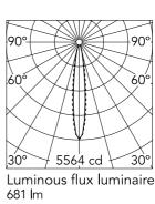
Beam Angle: 14° h(m) E(Ix) D(m) 1 5564 0.25 2 1391 0.50 3 618 0.74 4 348 0.99 5 223 1.24
