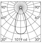
Luminous flux luminaire 682 lm
