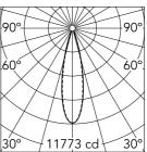
Luminous flux luminaire 2739 lm
