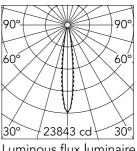
Luminous flux luminaire 2918 lm
