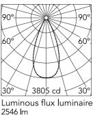
45° Beam Angle: D(<u>m)</u> E(Ix) h(m) 3805 0.83 1 2 951 1.65 3 423 2.48 3.31 4 238 5 152 4.13
