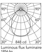
82° Beam Angle: D(m) h(m)  $E(\mathbf{x})$ 1.74 848 1 2 212 3.49 3 94 5.23 6.98 4 53 5 34 8.72
