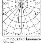
25° Beam Angle: E(Ix) D(m) h(m) 0.45 12611 1 2 3153 0.89 3 1401 1.34 1.78 4 788 5 504 2.23
