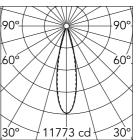
Luminous flux luminaire 2739 lm
