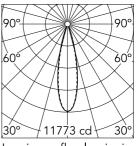
Luminous flux luminaire 2739 lm
