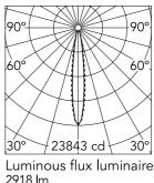
14° Beam Angle: E(Ix) D(m) h(m) 0.25 23843 1 2 5961 0.50 3 2649 0.74 1490 0.99 4 5 954 1.24
