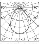
Luminous flux luminaire 1092 lm
