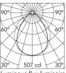
Luminous flux luminaire 1092 lm
