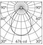
Luminous flux luminaire 1456 lm
