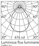
80° Beam Angle: E(Ix) D(m) h(m) 1.67 676 1 2 169 3.34 3 75 5.00 4 42 6.67 5 27 8.34
