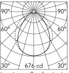
Luminous flux luminaire 1456 lm
