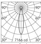
Luminous flux luminaire 1201 lm
