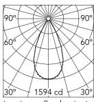
Luminous flux luminaire 1115 lm
