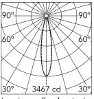
Luminous flux luminaire 581 lm
