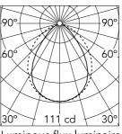
Luminous flux luminaire 223 lm
