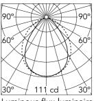
Luminous flux luminaire 223 lm
