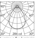
Luminous flux luminaire 571 lm
