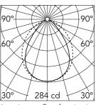
Luminous flux luminaire 571 lm
