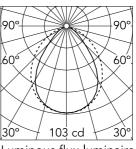
Luminous flux luminaire 207 lm
