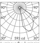
Luminous flux luminaire 762 lm
