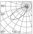
Luminous flux luminaire 510 lm
