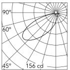
Luminous flux luminaire 510 lm
