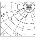
Luminous flux luminaire 510 lm
