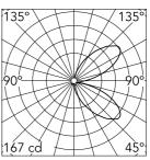
Luminous flux luminaire 1046 lm
