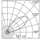
Luminous flux luminaire 523 lm
