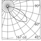
Luminous flux luminaire 523 lm
