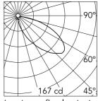
Luminous flux luminaire 523 lm
