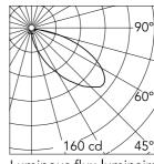
Beam Angle: 45° h(m) E(lx) D(m) 160 2.68 1 2 5.36 40 3 18 8.04 4 10 10.71 5 6 13.39
