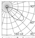
45° Beam Angle: h(m) E(lx) D(m) 160 2.68 1 2 5.36 40 3 18 8.04 4 10 10.71 5 6 13.39
