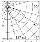
Luminous flux luminaire 523 lm
