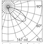
Luminous flux luminaire 523 lm
