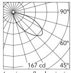
Luminous flux luminaire 523 lm
