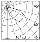
Luminous flux luminaire 523 lm
