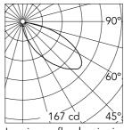
Luminous flux luminaire 523 lm
